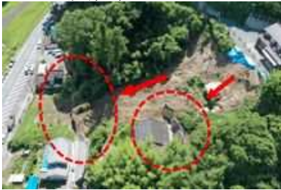
浜松市天竜区渡ヶ島 「渡ヶ島禿石（かぶろいし）」 （上空及び斜面下部より）【斜面高30m、崩壊幅25m、約500m 3 の土砂を捕捉】
