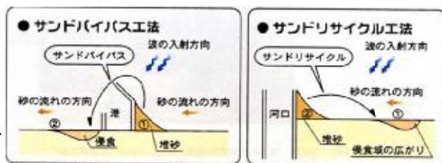
図：サンドバイパス/サンドリサイクルのイメージ (国交省作成資料より)
