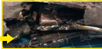
▲電源、音量ボタンがあった位置から大きく 裂け、バッテリー内部の電極が露出していた
