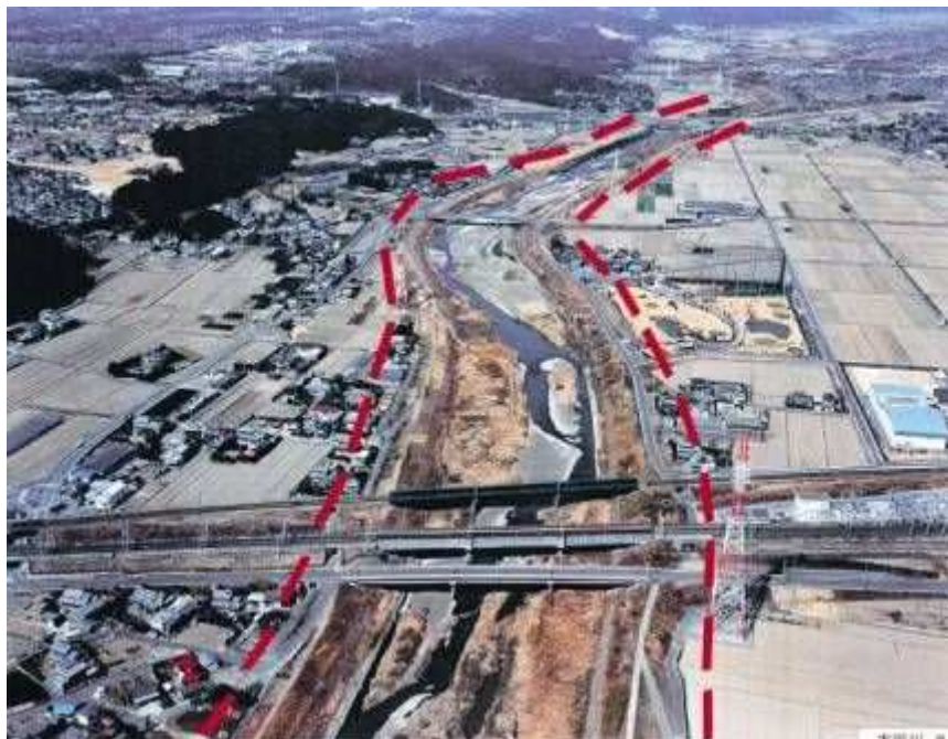
図 4 引堤方式による河川改修
