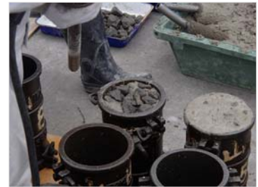
左) 大槌川防潮堤取壊し現場において、 コンクリート殻から採石を作る様子 上) 富古港でのリサイクルコンクリート 製作実験の様子 (国土交通省)
